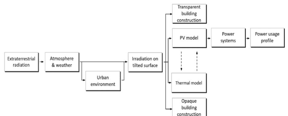
Fig. 2.: BIPV Model chain.
