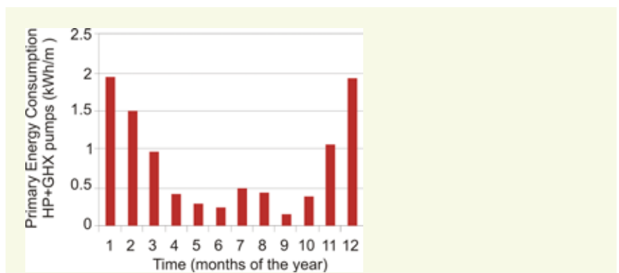
-Figuur 5- Primaire energie consumptie door de productie-unit van het gedetailleerde Geotabs-model
