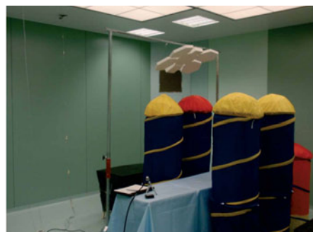
Figuur 3. Foto van de meetopstelling in de volledige operatiekamer. De getoonde opstelling van cilinders rond de operatietafel komt overeen met de opstelling zoals voorgeschreven in VDI 2167.
